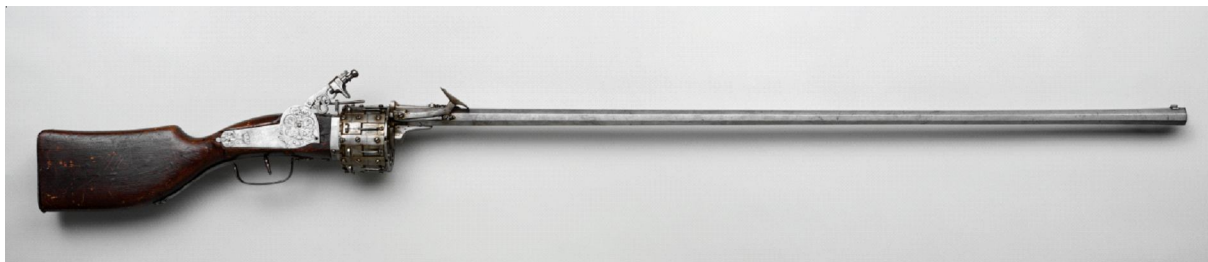
Рис. 1. Револьверное девятизарядное ружье с ударно-кремневым замком. Мастер Баргар Кинеман. Москва, Оружейная палата, 1664 г. ММК. Инв. № ОР-277
